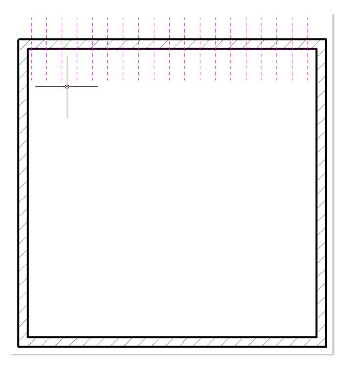
Fertig: Der Versatz beim Startpunkt 1 ist fix 5cm. Der Versatz bei Punkt 2 ist flexibel. Er beträgt mindestens 10cm, jedoch maximal 25cm. Es wurden 18 Unterteilungen mit identischen Abmessungen von jeweils 25cm erstellt.
