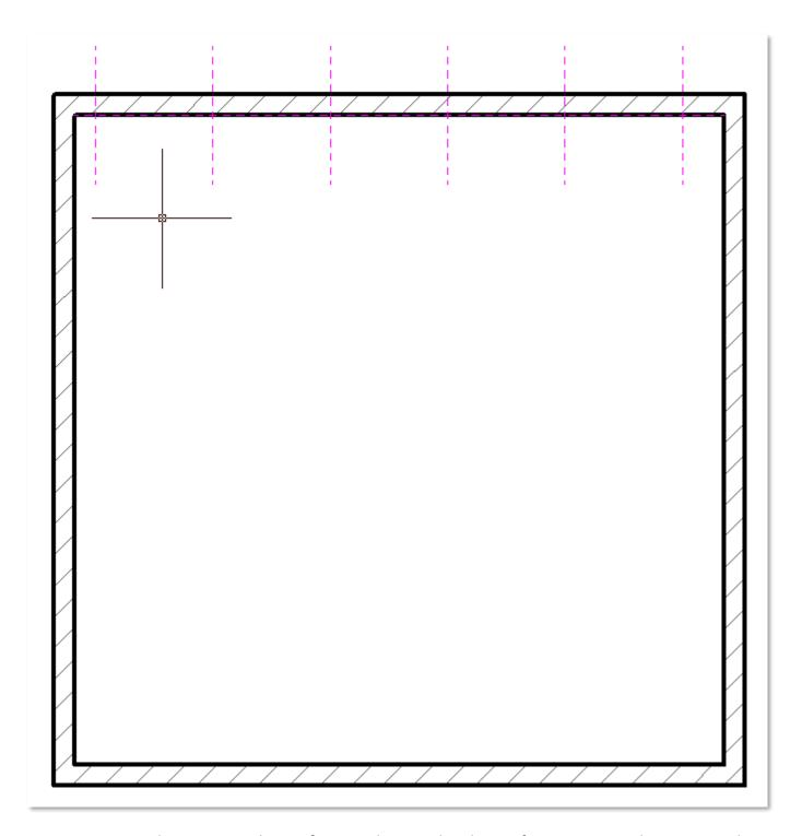
Fertig: Der Versatz beim Startpunkt 1 ist fix 15cm, beim Endpunkt 2 ist fix 30cm. Es wurden 5 Unterteilungen mit identischen Abmessungen erstellt.
