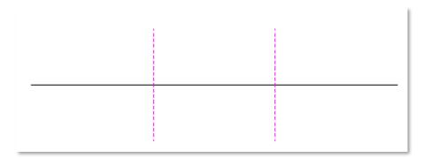
Strecke teilen und Strecke messen funktioniert nur für gerade Strecken, die zugleich mit den Trennlinien erstellt wird. Es kann zur definierten Strecke eine Ein- oder Ausrückung am Streckenanfang und am Streckenende eingestellt werden. Wird eingerückt, so ist das Mass als positive Zahl einzugeben. Die Teilungsstrecke wird dadurch verkürzt. Wird ausgerückt, so ist das Mass als negative Zahl einzugeben. Die Teilungsstrecke wird dadurch verlängert.
